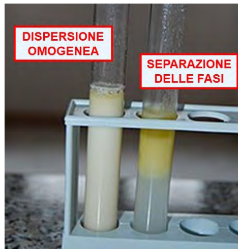
Figura 17. "Rottura" della dispersione omogenea e separazione delle due fasi.
